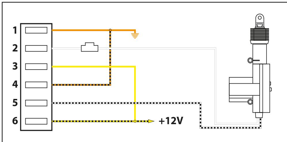
Před montáží centrální jednotky je třeba zjistit, zda původní měla pozitivní nebo negativní ovládání.
