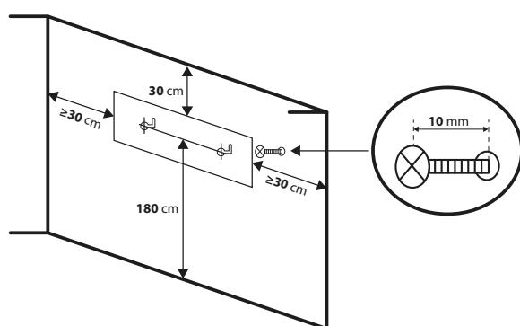
1. Pomocou ceruzky a vodováhy nakreslite na stenu vodorovnú čiaru, do požadovanej výšky.
