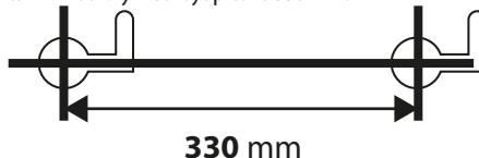
3. Pomocí vrtačky vyvrtejte montážní otvory. Na vrtání použijte 6 mm vrták. Hloubka otvorů musí být nejméně 26 mm hluboká. Nepoužívejte menší montážní velikost!
