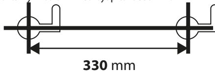
3. Pomocou vŕtačky vyvŕtajte montážne otvory. Na vŕtanie použite 6 mm vrták. Hĺbka otvorov musí byť najmenej 26 mm hlboká. Nepoužívajte menšiu montážnu velkosť!
