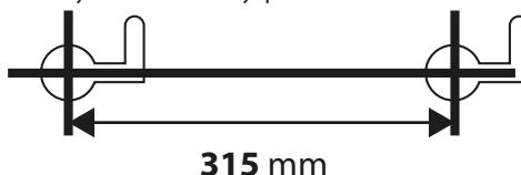
3. Pomocou vrtačky vyvŕtajte montážne otvory. Na vŕtanie použite 6 mm vrták. Hĺbka otvorov musí byť najmenej 26 mm hlboká. Nepoužívajte menšiu montážnu veľkosť!
