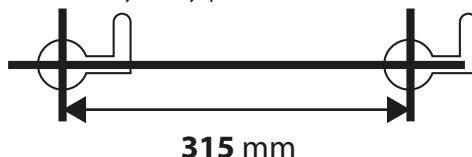
3. Pomocí vrtačky vyvrtejte montážní otvory. Na vrtání použijte 6 mm vrták. Hloubka otvorů musí být nejméně 26 mm hluboká.
